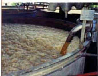
Cuve en fin de remplissage et en cours de fermentation.
